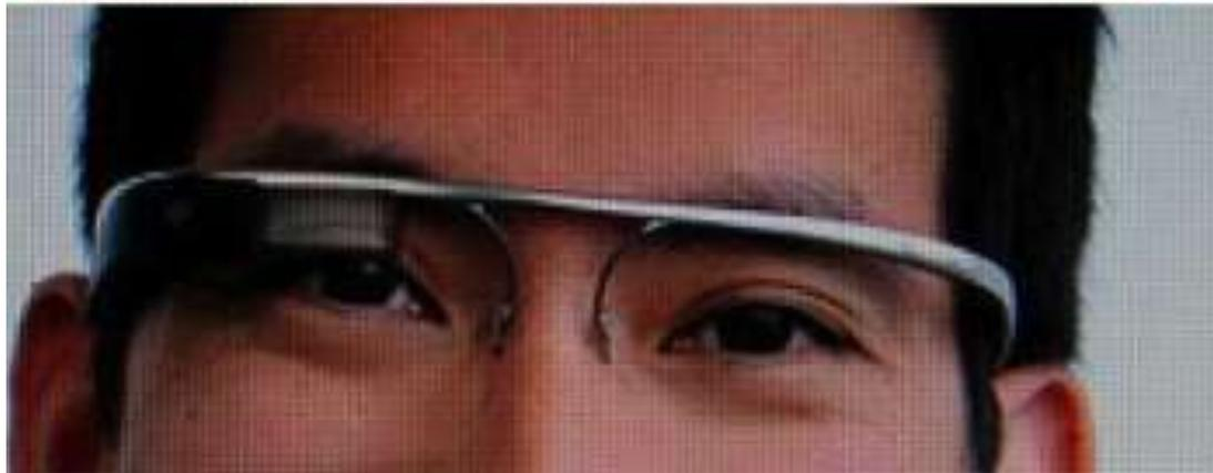
Google Glass visualizza una finestra in sovrapposizione sulla realtà, e attraverso il comando vocale può attivare le operazioni di smartphone e/o tablet.
