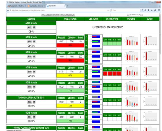
Tracking sheets elettronici in ogni Microplant produttivo per la dichiarazione della produzione oraria di pezzi buoni e difettosi (registrati per tipo di difettosità).
