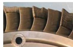
**Riparazione di particolari delle turbine con tecnologia LMD**
