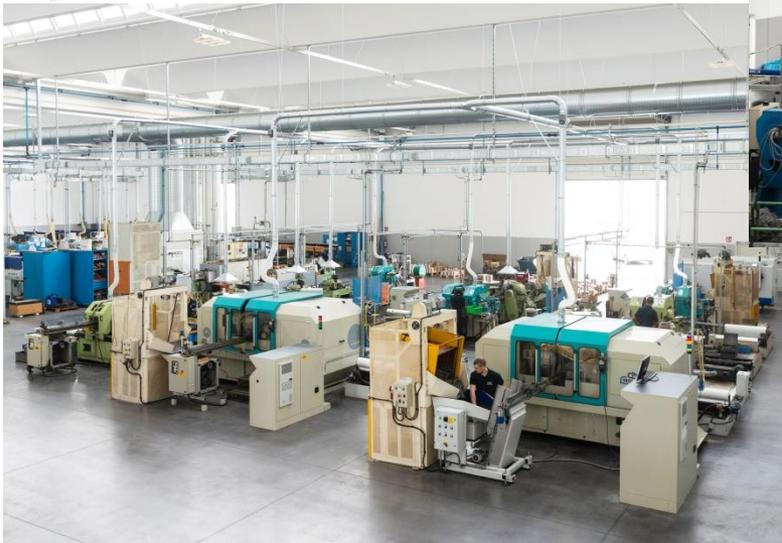
Dispone di un parco macchine interamente a controllo numerico in grado di produrre minuteria metallica da 3 a 51 mm in svariate forme geometriche
