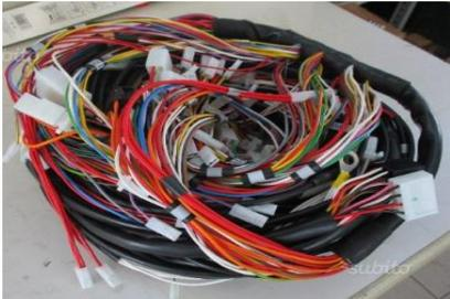
cablaggio elettrico tradizionale con collegamenti punto a punto
