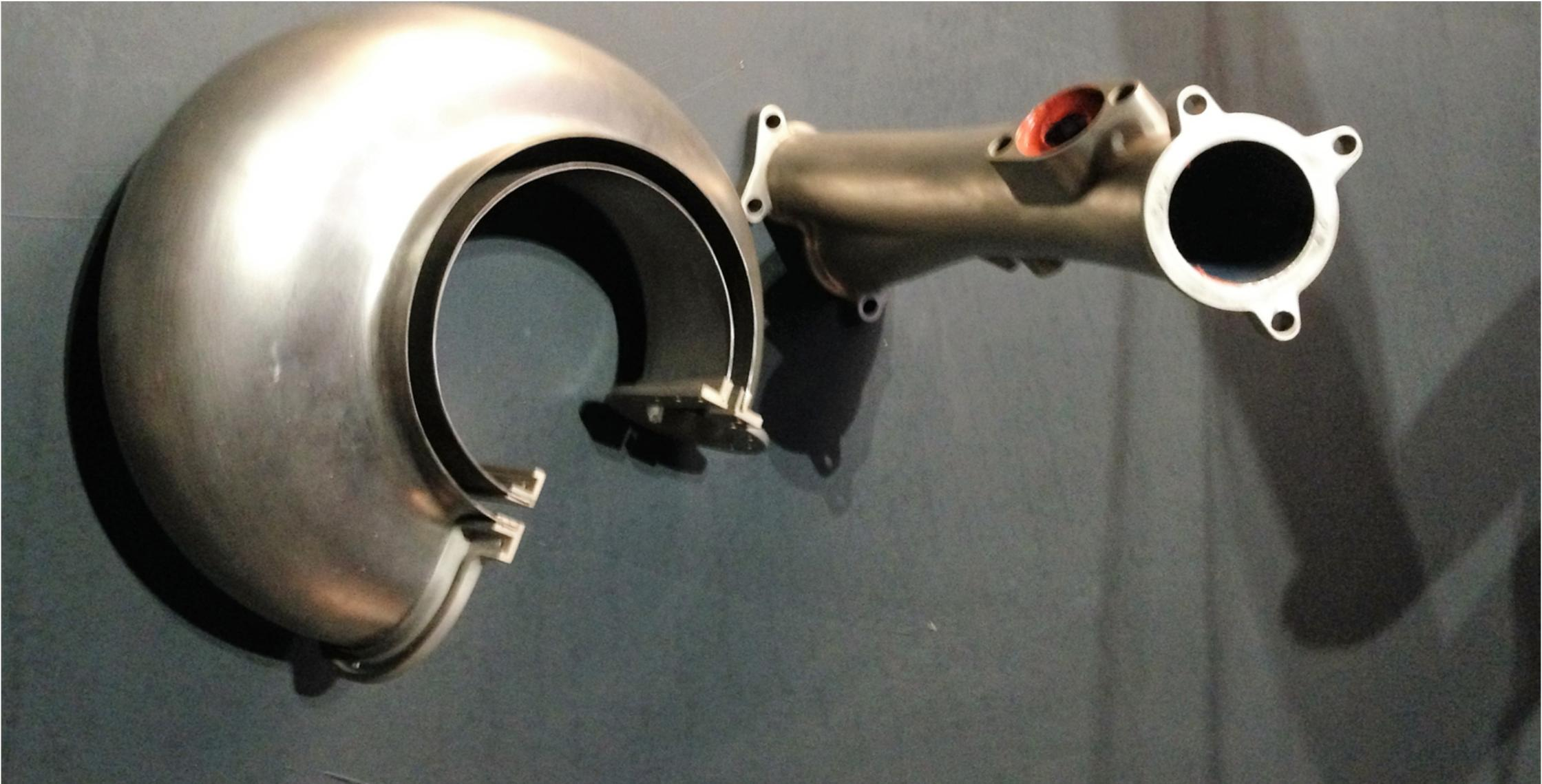
Prototipo dimostrativo realizzato con un'anima a perdere di resina tramite stereolitografia dopo carteggiatura e finitura la resina viene rivestita con strato di circa 0,8-1,0 mm di nikel elettroformato, il manufatto viene liberato dall'anima in resina ed il pezzo in metallo è pronto all'uso.
