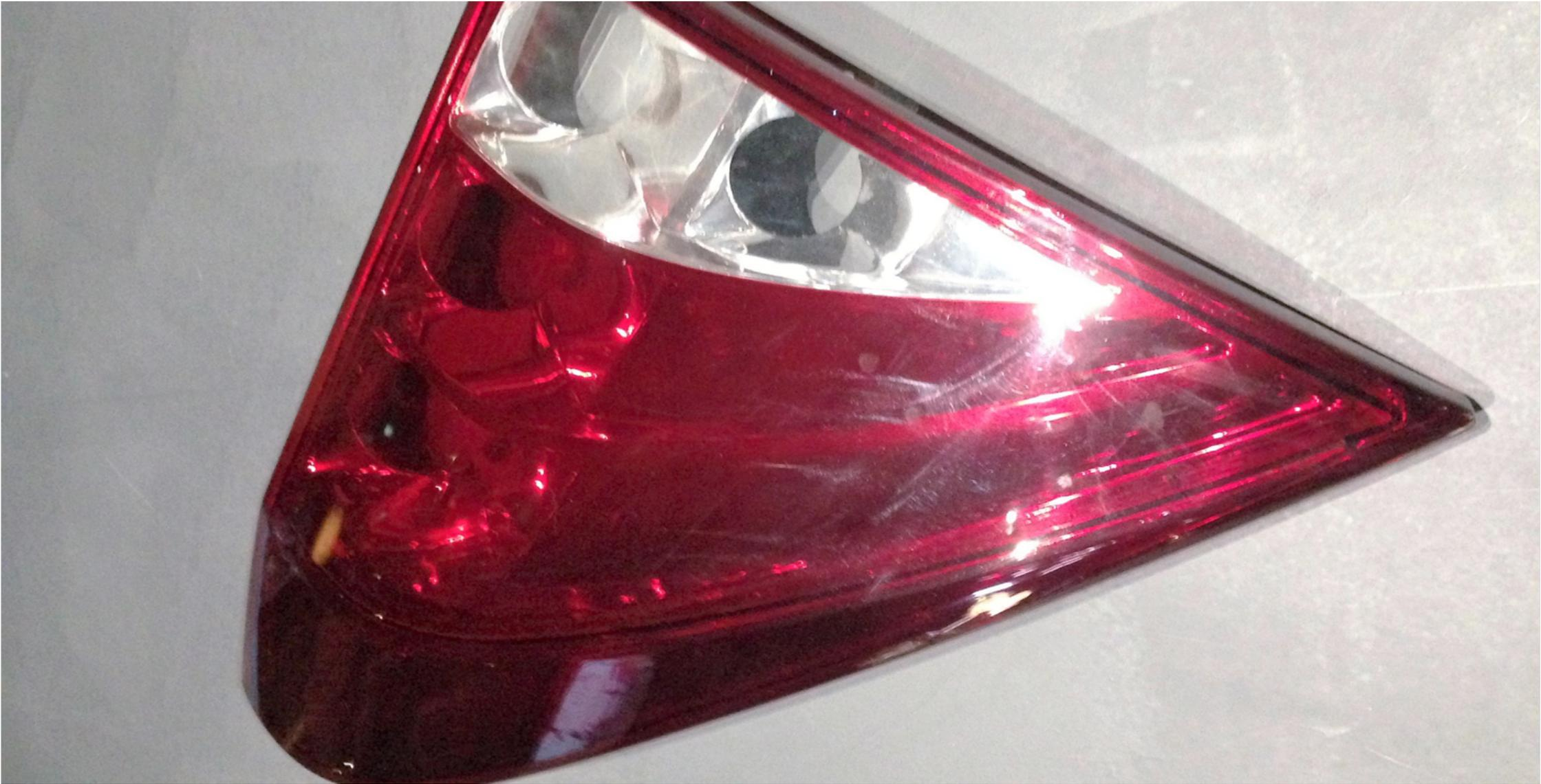
Prototipo funzionale. Master costruito in resina tramite stereolitografia, carteggiato e verniciato. Con i master vengono realizzati stampi in silicone, i pezzi sono ottenuti per sovrastampaggio di poliuretani (colorato e trasparente) colati sottovuoto; trattamento di alluminatura sottovuoto.
