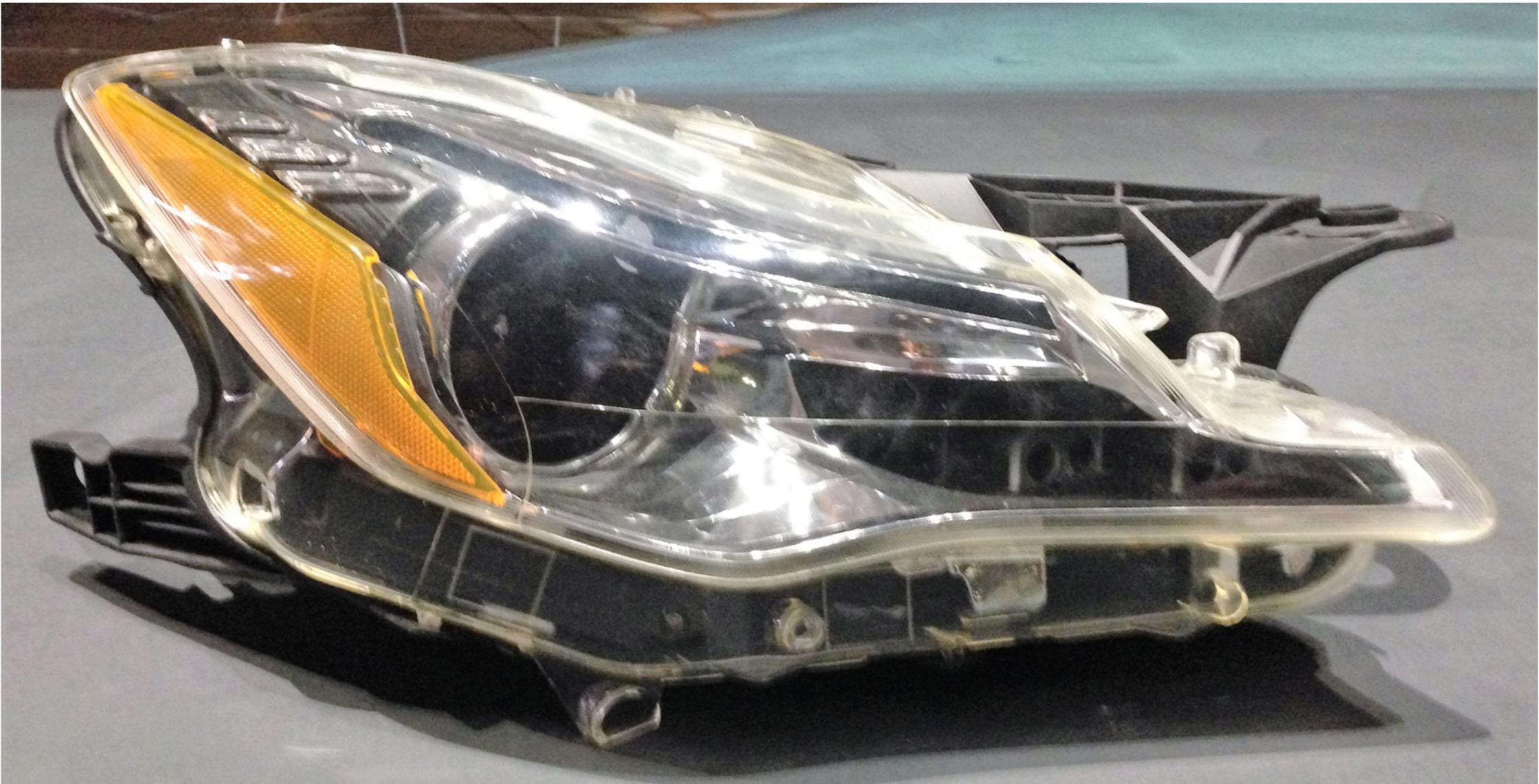
Prototipo funzionale. Master costruito in stereolitografia, carteggiato e verniciato; con i master vengono realizzati gli stampi al silicone; i pezzi sono ottenuti per stampaggio sotto vuoto; alluminatura sotto vuoto.
