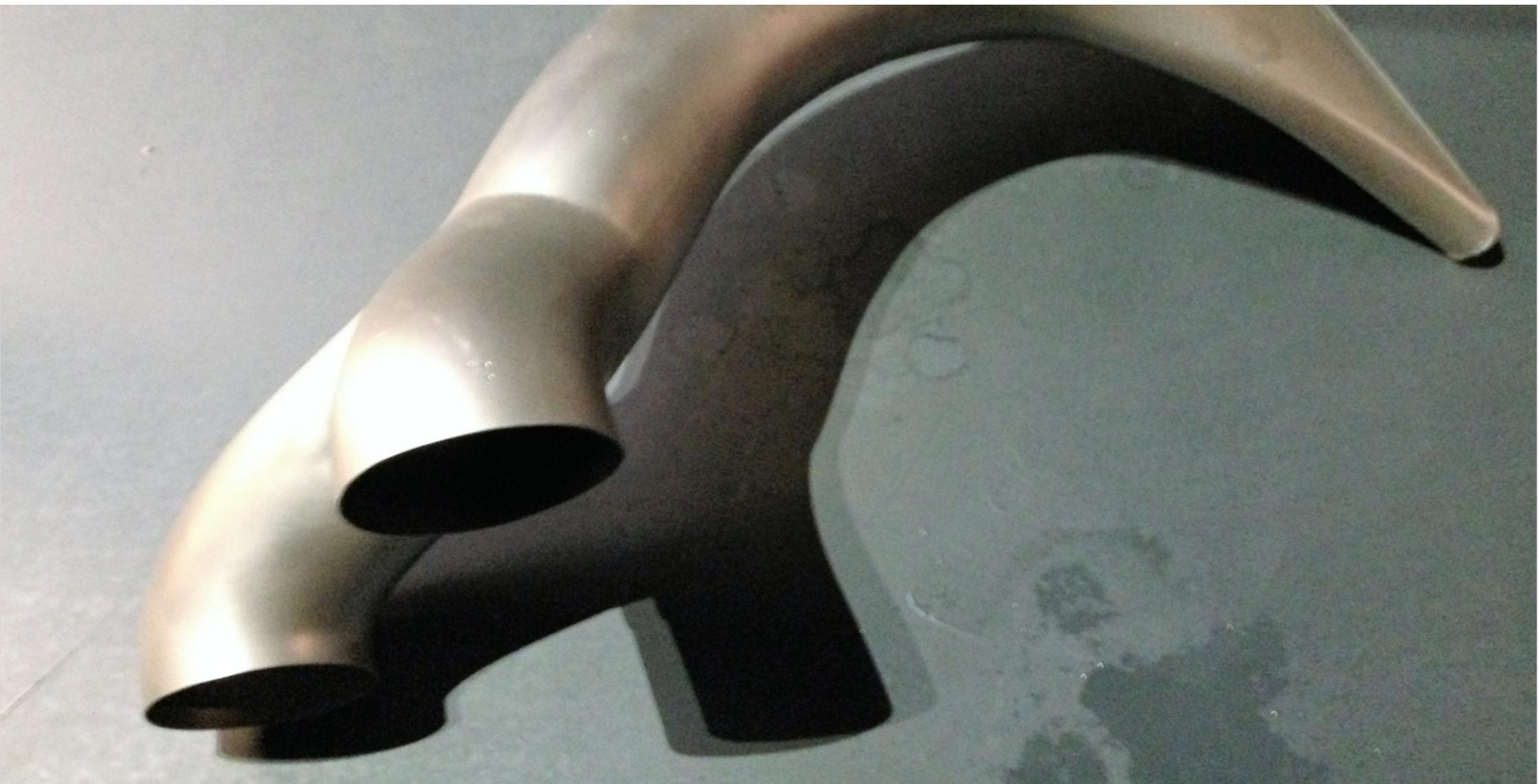
Realizzato in resina caricata con ceramica, tramite stereolitografia rivestito con strato sottile (0,15 mm c.ca) di nikel elettroformato, l'abbinamento dei due materiali determina una struttura a sandwich che ha il pregio di aumentare in misura cospicua le prestazioni meccaniche del pezzo.
